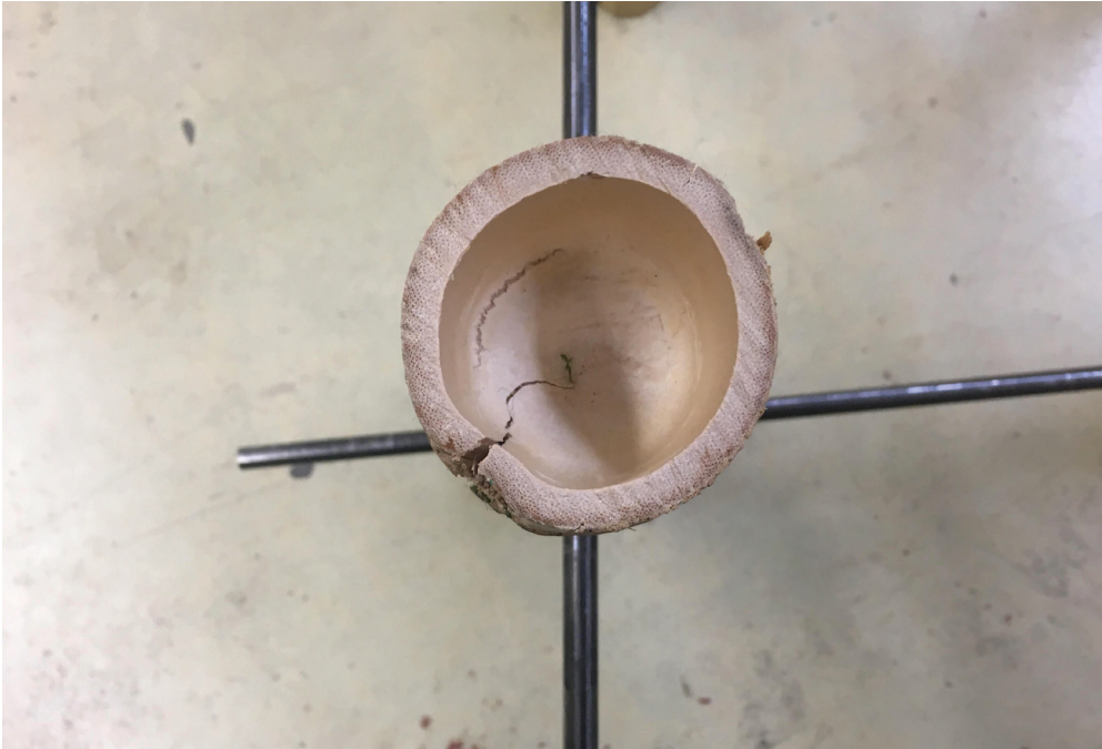
Détail de la coupe du bambou au niveau de son noeud
